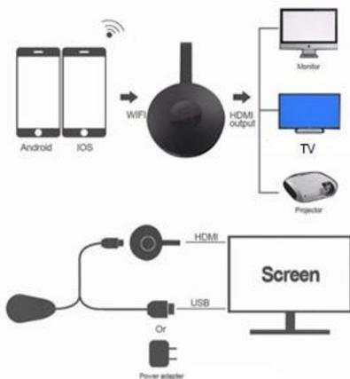
1. Encienda su televisor y el dongle conectando el cable USB del dongle a un adaptador USB (5 V 1 A). Coloque el receptor de wifi en un lugar con buena recepción de wifi.
